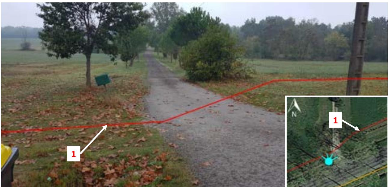
**1 : Branchement DN80 EMISSION EX SINERG A MONTECH projeté**
