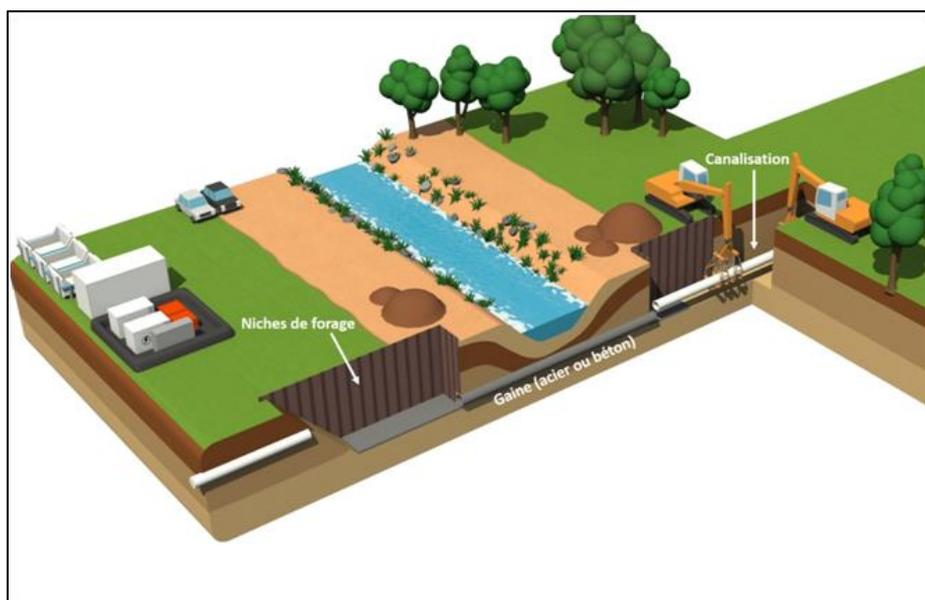
**Figure 46 : Schéma de principe de mise en place d'un franchissement par fonçage, forage horizontal / microtunnelier**
